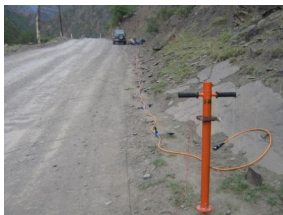
Рис. 6. Развертывание сейсмокосы на типичной площадке /
