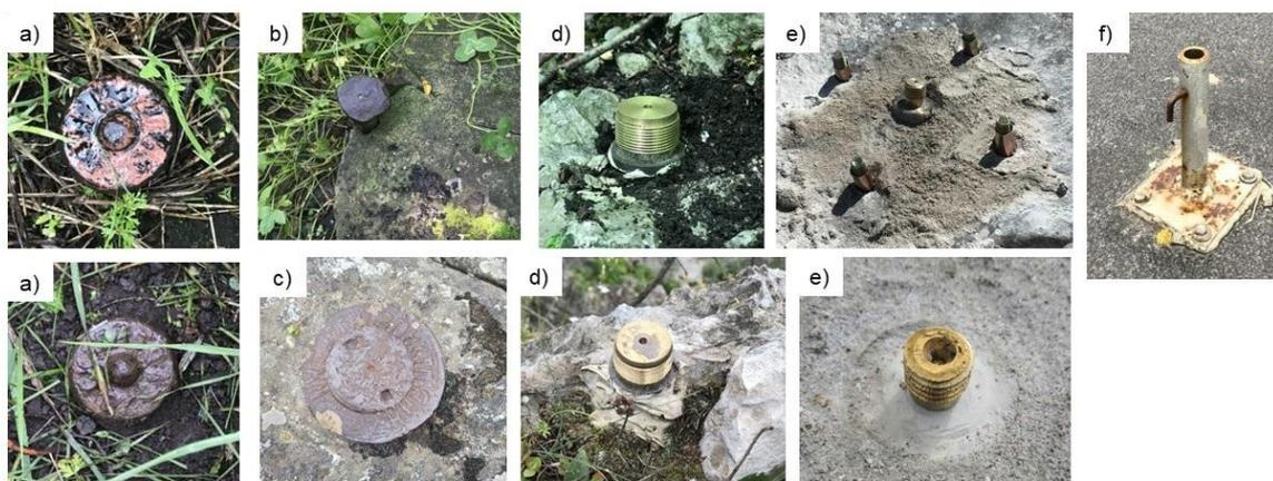
Рис. 1. Типы геодезических центров на Осетинском геодинамическом полигоне.
