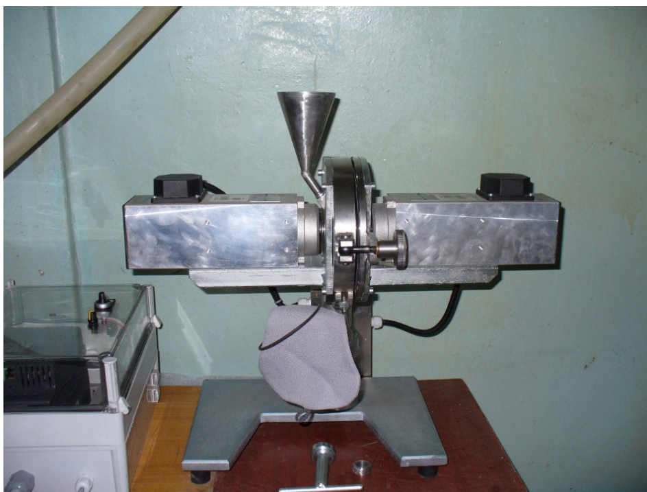
Рис. 2. Лабораторный дезинтегратор Дез-11 /
