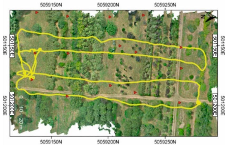
Рис. 2. Район работ: желтые линии – трассы полета БПЛА, красные треугольники – GPS отметки /
