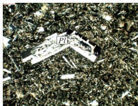
Рис. 2-2. Диабазовый порфирит. Структура порфировая. Основная масса – микродиабазовая (Д-2,9) / Fig. 2-2. Diabase-porphyrity. Texture porphyritic, basic mass is microdiabasic (D-2.9)
