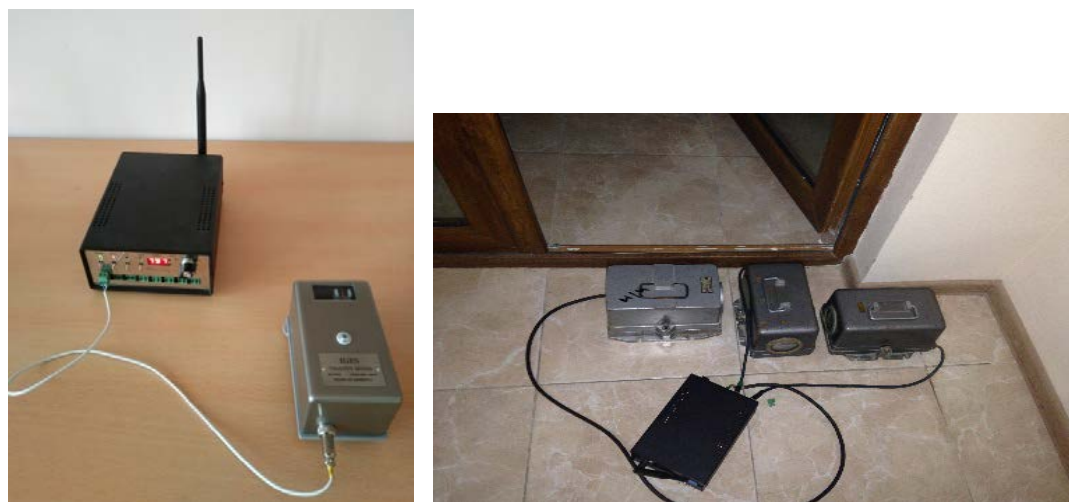
Рис. 2. Мобильная сейсмостанция производства ИГИС НАН РА /
