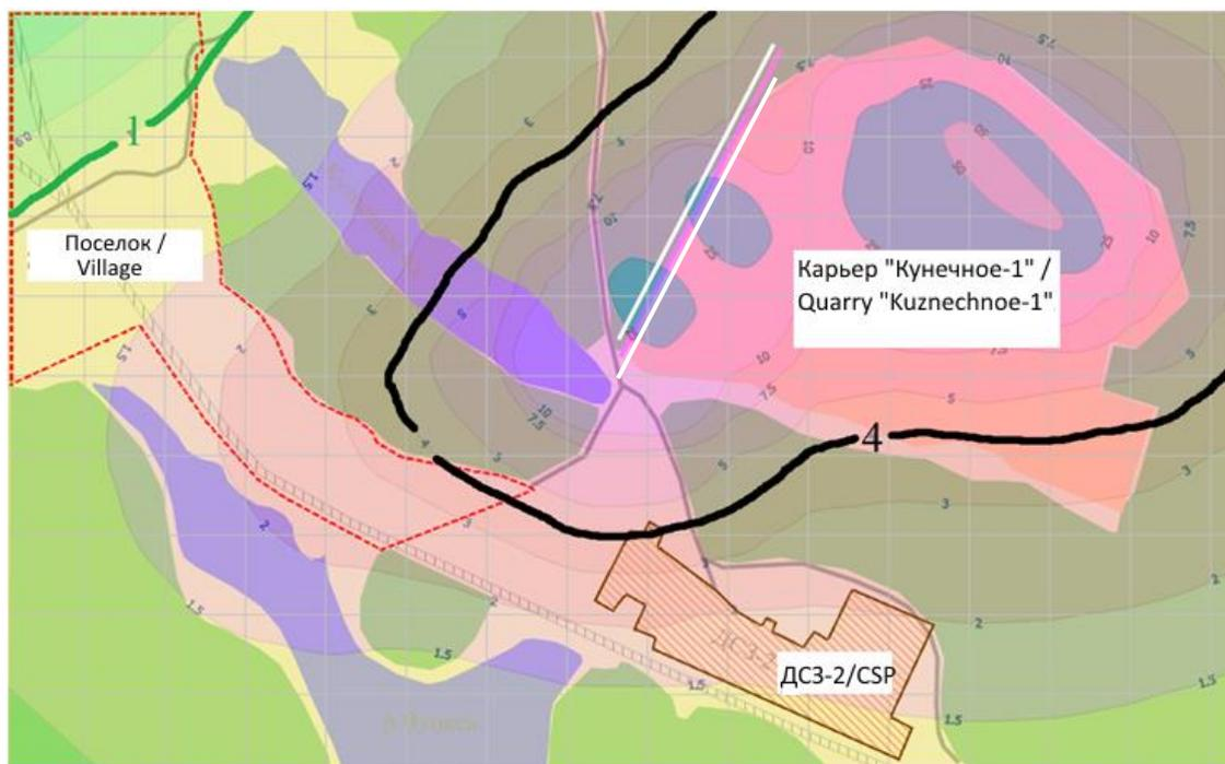
*Рис. 7. Результат расчета рассеивания пыли неорганической 70-20% SiO<sub>2</sub> при учете пылезащитного экрана, как дополнительного элемента рельефа местности. /*
