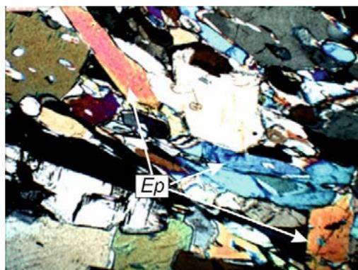
Рис. 1-2. Гранобластическая структура основной ткани.
