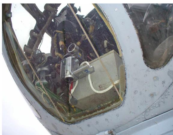
Рис. 2. Видеокамеры прямого и вертикального обзора
