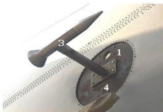
Рис. 3а. Блок приборов на заглушке иллюминатора
