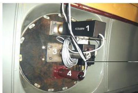
Рис. 3б. Блок приборов с охранными кронштейнами
