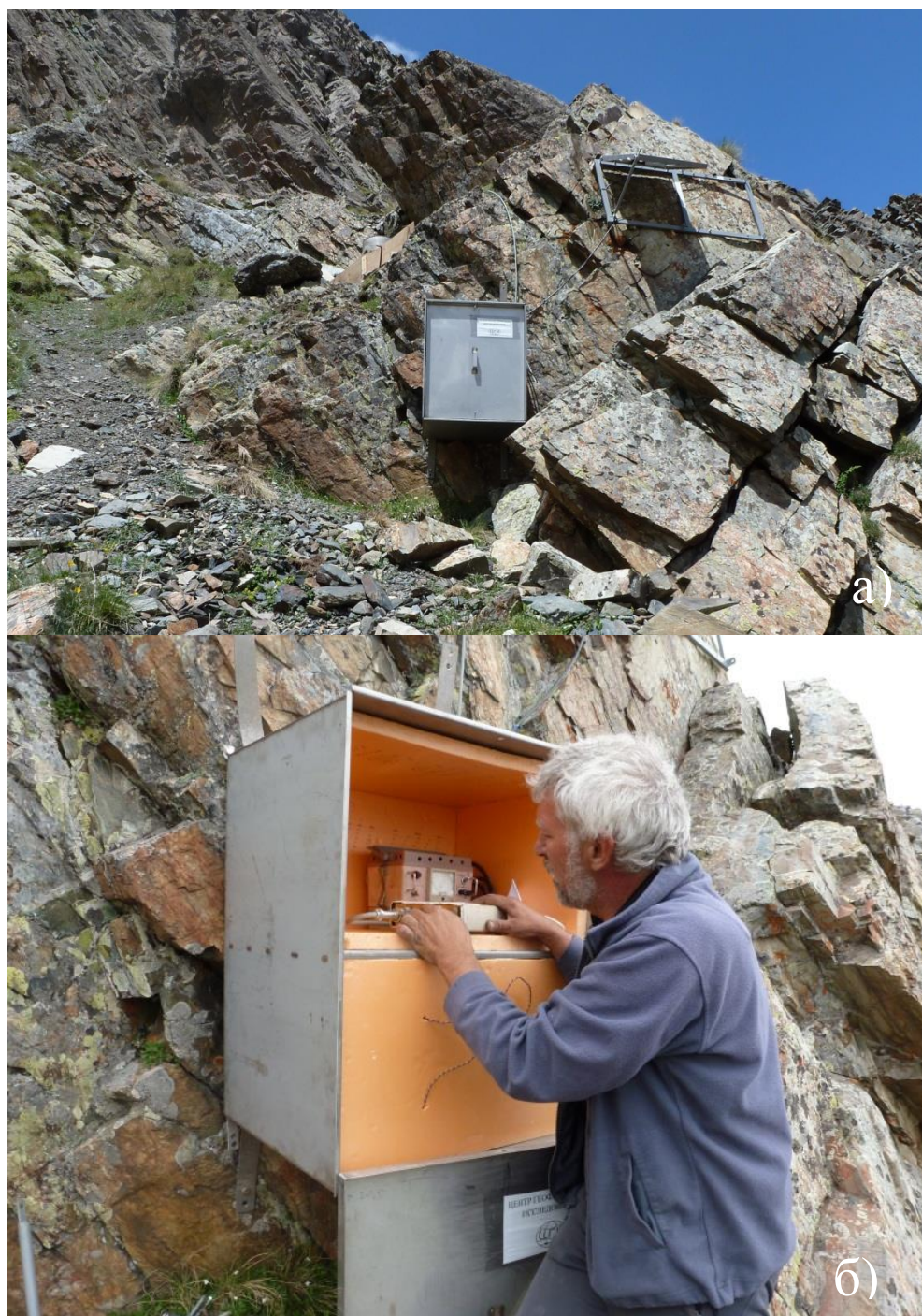
Рис. 3. Оборудование сейсмической станции «Колка» (а) процесс обслуживания сейсмической станции (б)
