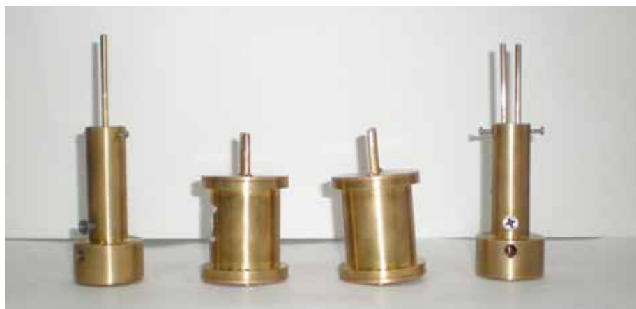
Рис. 10. Фото сейсмопреобразователей на основе коаксиального объемного резонатора СВЧ на волне H_{01} и ТЕМ
