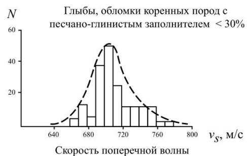
Рис. 3. Гистограммы распределения скоростей поперечных волн в крупнообломочных грунтах
