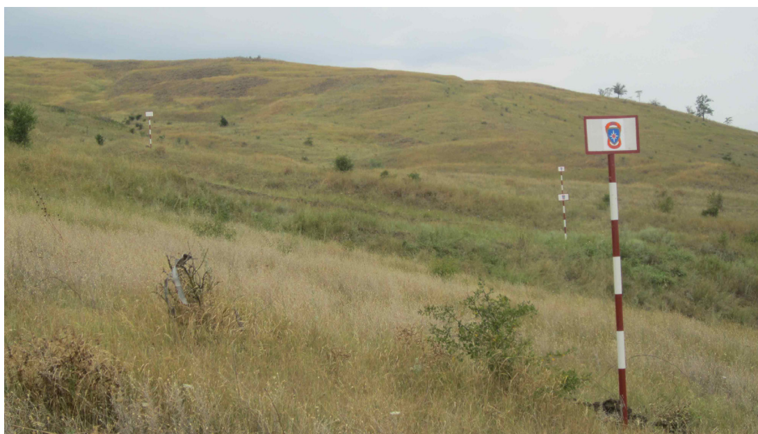
Рис. 4. Фрагмент поперечных створов поверхностных реперов
