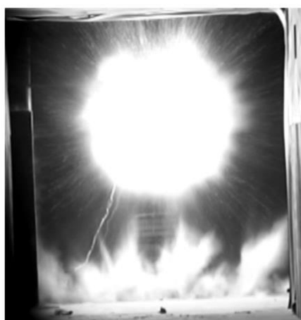
Рис. 4. Видеокادر срабатывания взрывного генератора. Диаметр тела свечения ~1,2 м
