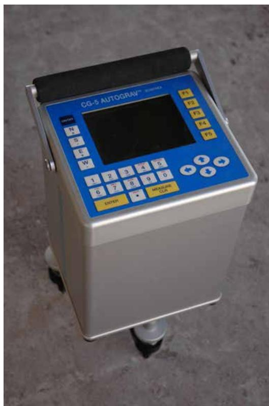
Рис. 2. Относительный гравиметр CG5 канадской фирмы Scintrex
