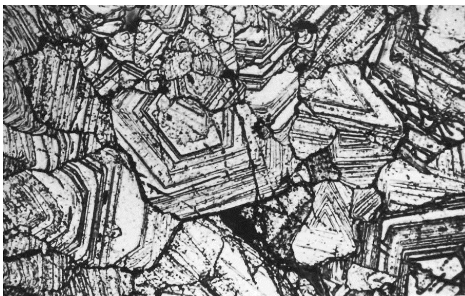
Рис. 3. Кристаллически зрелый пирит с зональностью роста. Массивные серноколчеданные руды Худесского месторождения. Протравлено \text{HNO}_3 + \text{CaF}_2 , увеличение 30\times .
