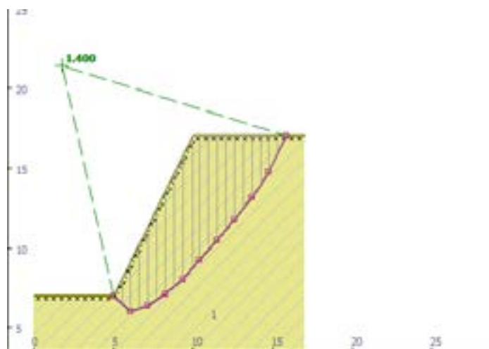
Рис. 6. Результаты определения коэффициента устойчивости в GeoStab при n=10 / Fig. 6. The results of determining the stability coefficient in GeoStab at n=10
