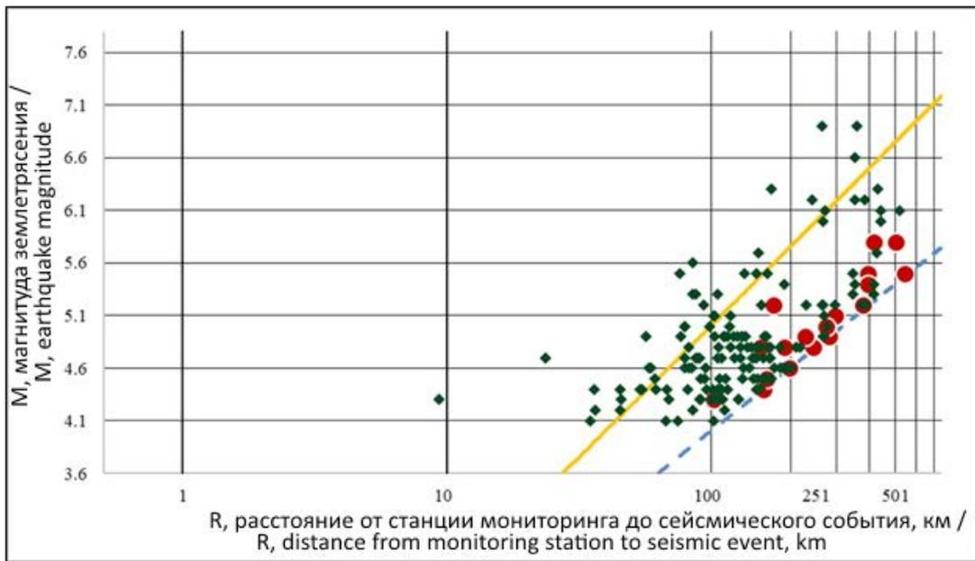
Рис. 1. Тектонические землетрясения в поле значений ОАР. Ромбами обозначены события, отразившиеся в кривых аномалий ОАР. Точками обозначены события, которые не отразились в кривых аномалий ОАР. Жёлтая прямая линия соответствует  $K=2,5$ ; прерывистая прямая линия соответствует отношению  $K=2$  [Козлова и др., 2021] /
