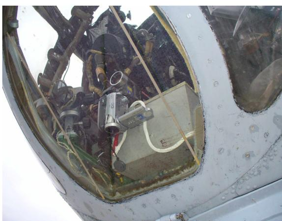
Рис. 2. Видеокамеры прямого и вертикального обзора
