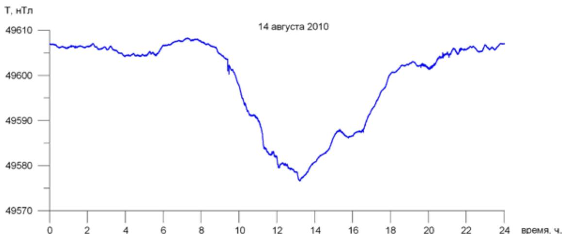
Рис. 2. Пример записи магнитных вариаций в восточной части Передового хребта
