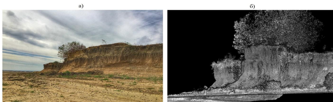
Рис. 2. Типичные для исследуемого участка клифы абразионных обвально-просадочных берегов на фото (а) и виде точек лазерных отражений (б). Дата съемки – 09.09.2023 /
