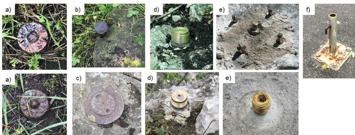
Рис. 1. Типы геодезических центров на Осетинском геодинамическом полигоне. а – грунтовые свайные центры (тип 147) (пункты ППК «Роскадастр») [Правила ..., 1993]; б – грунтовые анкерные центры (тип 162) (пункты ППК «Роскадастр») [Правила ..., 1993]; с – скальные центры (пункты ППК «Роскадастр») [Правила..., 1993]; д – скальный центр с принудительным центрированием, резьба М4.5 [Миронов и др., 2021] (пункты ВНИЦ РАН и ГАИШ МГУ); е – скальный центр с принудительным центрированием, резьба 5/8 дюйма [Маневич и др., 2022] (пункты Геофизического центра РАН); ф – вставной трубчатый центр с адаптером [Певнев и др., 2014] (пункт ГФИ ВНИЦ РАН) /
