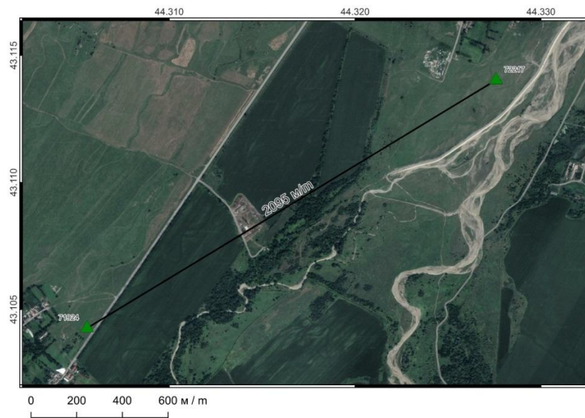
Рис. 8. Схема измерений базовой линии /
