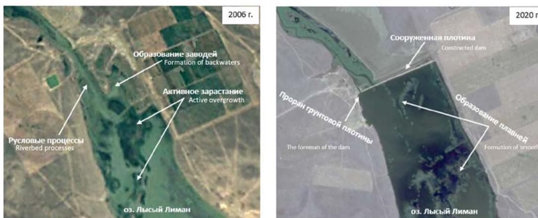
Рис. 1. Динамика акватории озера Лысый Лиман при строительстве гидротехнического сооружения /
